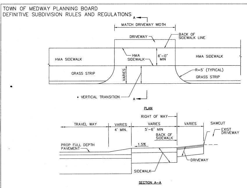
\* DRIVEWAY SHALL BE SLOPED TO MEET BACK OF SIDEWALK FINISHED GRADE.
